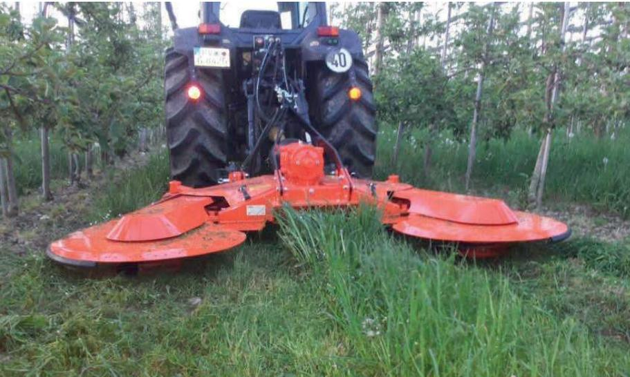
Bei älteren Mulchgeräten kann manchmal noch ein Messer so ausgebaut werden daß man den Blühstreifen in der Mitte stehenlassen kann. Es gibt auch kreative Möglichkeiten, neuere Mulchgeräte umzubauen, so daß ein Mittelstreifen ausgespart werden kann. (Foto N. Glocker)
